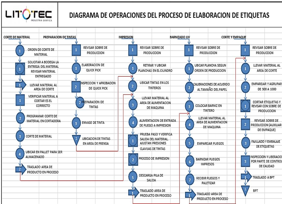
Figura 33. Diagrama de operaciones del proceso. Empresa Litotec S.A. Información tomada de (Quinde Gonzabay, 2016). Elaborado por el autor
